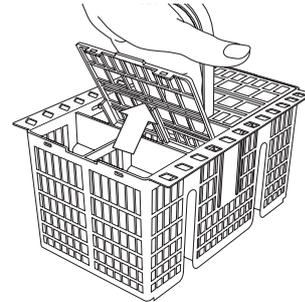
**Los cuchillos y otros utensilios con bordes afilados se tienen que colocar en el cesto de cubiertos con las puntas hacia abajo o se deben colocar horizontalmente en los compartimentos desplegables de la bandeja superior.**
