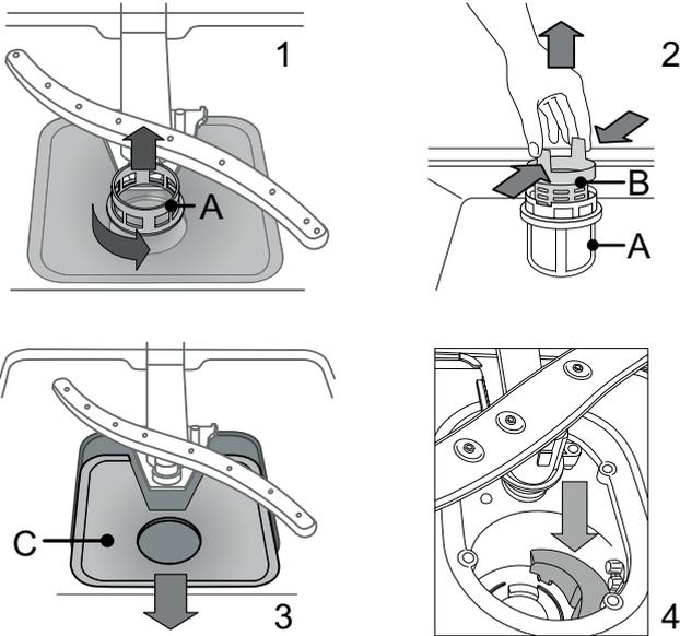
Una vez limpiados los filtros, recolocque el conjunto de filtrado y encájelo correctamente en su sitio; esto es esencial para garantizar el funcionamiento eficiente del lavavajillas.
